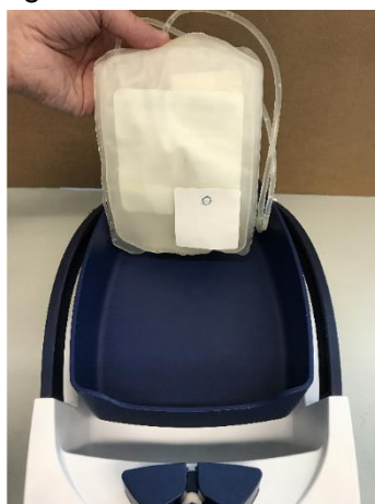
Abbildung 27: RFID Tag Position unterste Beutel
