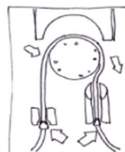
5.6. Wprowadzanie drenu Qiona®
