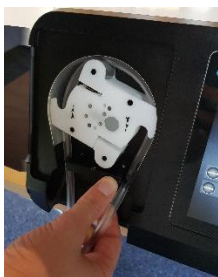
Фигура 23: Десен край на маркуча от десния фиксатор на маркуча
