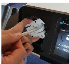
Фигура 24: Ръчно завъртане на ротора обратно на посоката на стрелката
