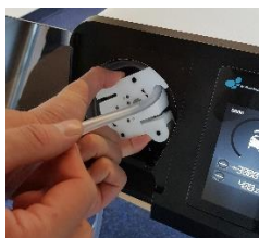
Obrázek 24: Ruční otočení rotoru proti směru šipky
