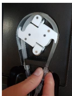
Εικόνα 10: Τοποθέτηση τμήματος αντλίας
