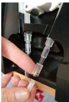
Εικόνα 11: Χαλαρώστε το πώμα ασφάλισης
