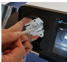
Εικόνα 24: Περιστροφή ρότορα κατά την αντίθετη φορά από το βέλος με το χέρι
