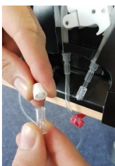
Εικόνα 12: Χαλαρώστε το πώμα ασφάλισης
