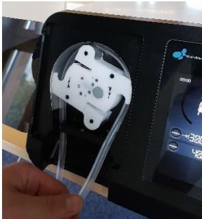
Εικόνα 20: Σετ εύκαμπτων σωλήνων στη βάση
