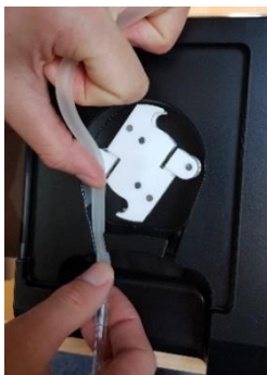
Εικόνα 8: Τοποθέτηση τμήματος αντλίας
