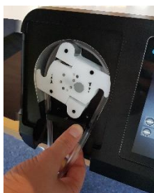
Εικόνα 23: Αφαίρεση δεξιού άκρου εύκαμπτου σωλήνα από τη βάση εύκαμπτων σωλήνων
