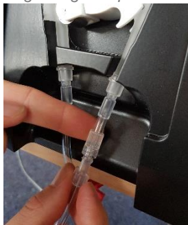
Joonis 13: Voolikukomplekti 1 ühendamine 2 külge
