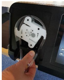
Joonis 23: Parempoolne voolikuots voolikuhoidikust välja
