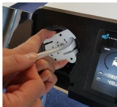
Joonis 24: Pöörake rootorit käega noole suuna vastassuunas
