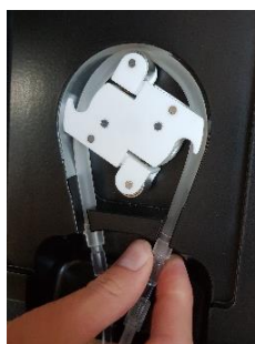
Kuva 10: Pumppusegmentin asettaminen paikalleen
