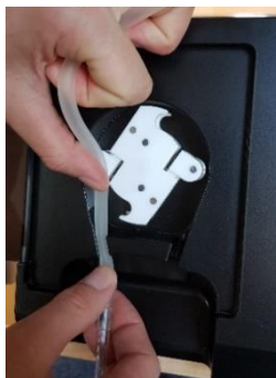
Slika 8: Umetanje segmenta pumpe
