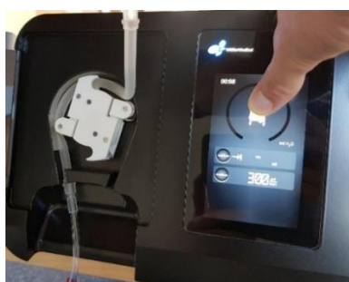
Slika 9: Umetanje segmenta pumpe
