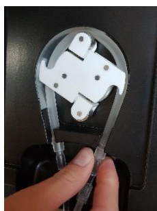
Kép 10: Szivattyúszegmens behelyezése
