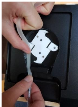
Kép 8: Szivattyúszegmens behelyezése
