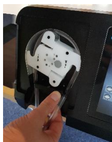
Figura 23: Rimozione dell'estremità destra del tubo dal portatubo
