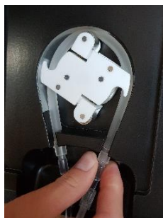
Ilustracja 10: Zakładanie segmentu pompy
