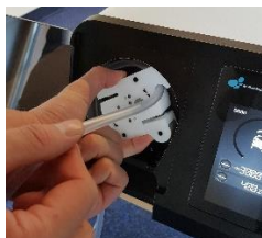
Ilustracja 24: Obracanie ręczne wirnika przeciwnie do kierunku strzałki
