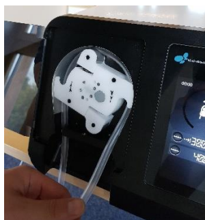
Figura 20: Conjunto de tubos no suporte
