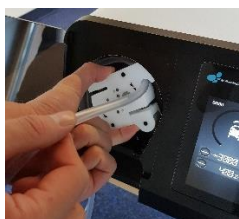
Obrázok 24: Otáčajte rotorom ručne proti smeru šípky
