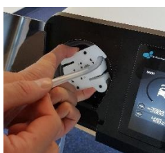
Slika 24: Rotor ročno obrnite nasproti smeri puščice
