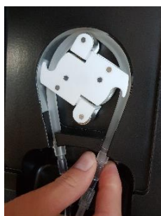
Slika 10: Vstavljanje segmenta črpalke
