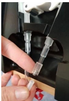
Slika 11: Odvijte zaporni pokrovček
