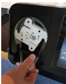
Slika 23: Desni konec cevke iz držala za cevke
