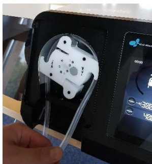
Bild 20: Slangsets i hållare
