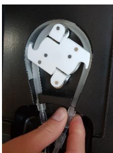
Bild 10: Sätt i pumpsegmentet
