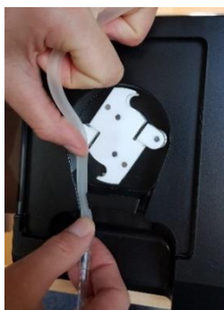
Bild 8: Sätt i pumpsegmentet
