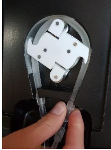
Resim 10: Pompa segmentinin yerleştirilmesi
