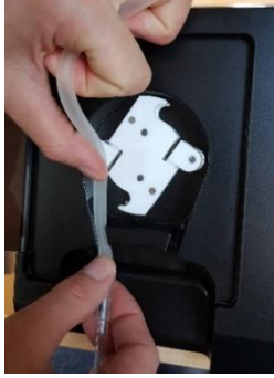
Resim 8: Pompa segmentinin yerleştirilmesi
