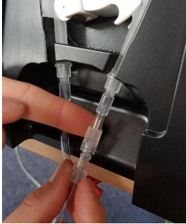
Resim 13: Hortum seti 1'in 2 ile birleştirilmesi
