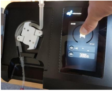
Resim 9: Pompa segmentinin bağlanması
