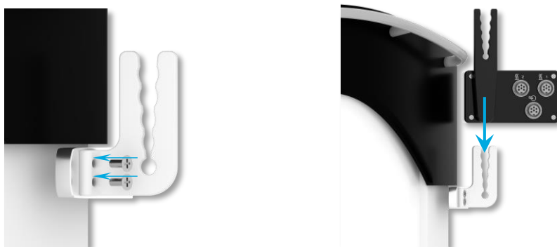
Obrázek 5: Montáž držáku hadiček a zapojení ovládací jednotky
