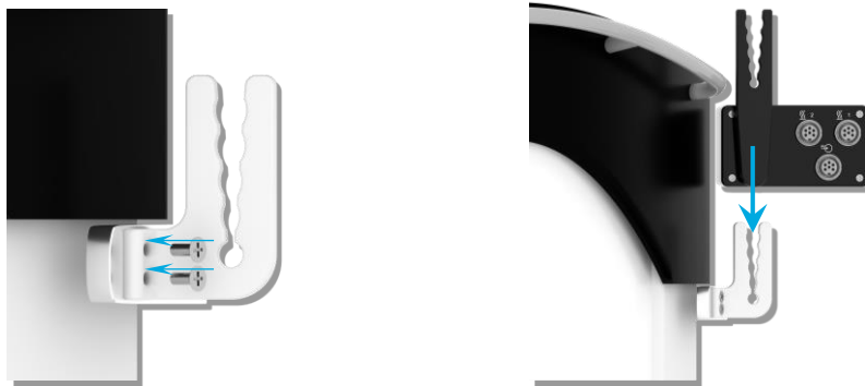
Figura 5: Montar el soporte de tubo e introducir la consola
