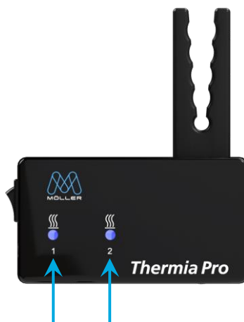
Slika 10: LED simboli na konzoli Thermia Pro
