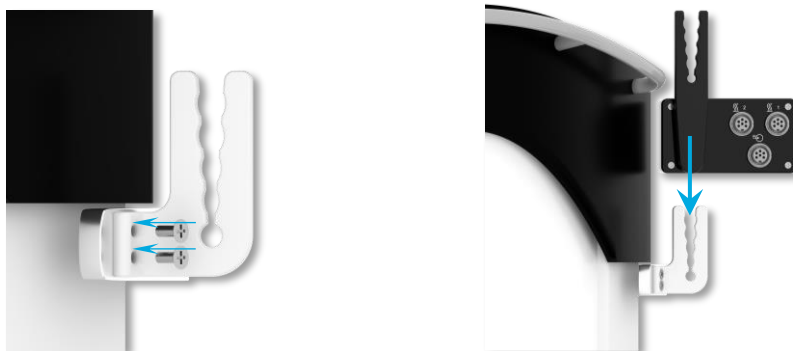
Kép 5: Szerelje fel a tömlőtartót és dugja be a konzolt
