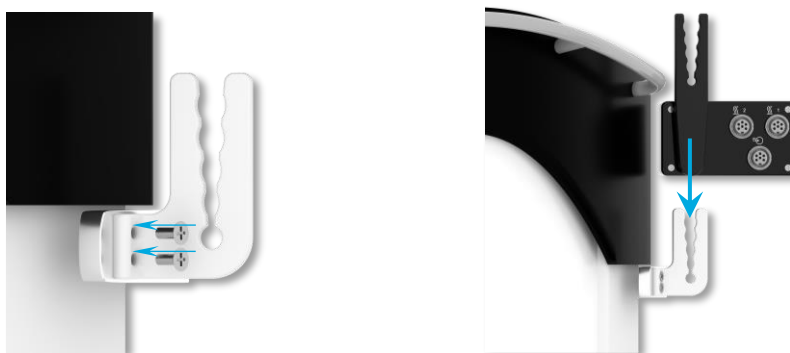
5 pav. Vamzdelių laikiklio montavimas ir Console prijungimas
