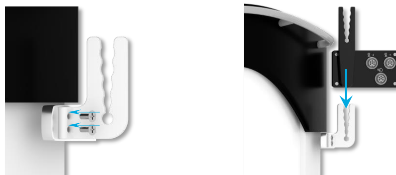
Afbeelding 5: Slanghouder monteren en console insteken
