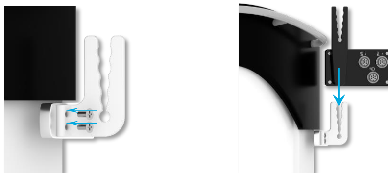
5 pav. Vamzdelių laikiklio montavimas ir Console prijungimas
