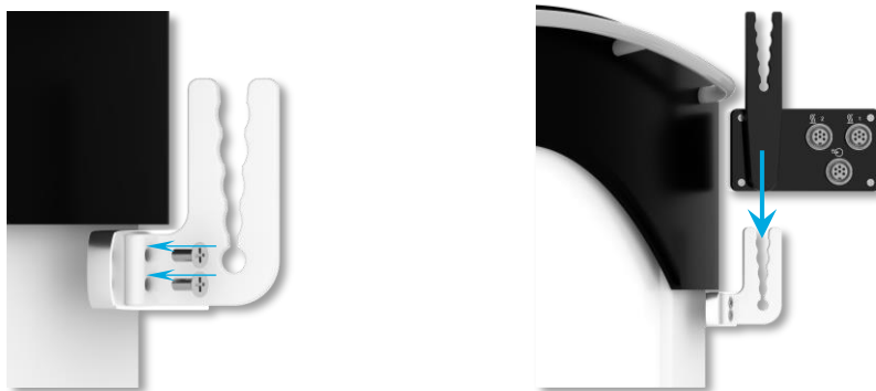
Ilustracja 5: Montaż uchwyty na rurki i umieszczanie konsoli
