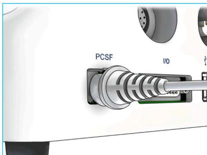
Conecte o cabo do sensor ao *LiquoGuard*®7.
