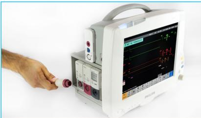
Conecte uma extremidade do cabo de interface no monitor de cabeceira e a outra extremidade no *LiquoGuard®7*.
