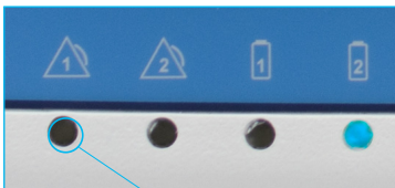
Alarma visual desactivada
