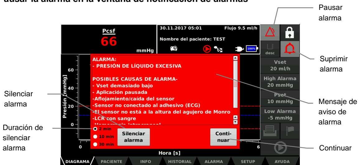
Figura 21: Composición de la ventana de notificación de alarma en caso de una condición de alarma fisiológica o técnica.
