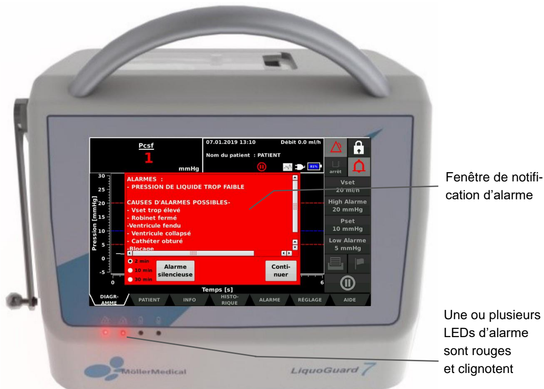
Illustration 20 : Signaux d'alarme visuels du LiquoGuard®7 en présence d'une condition d'alarme.
