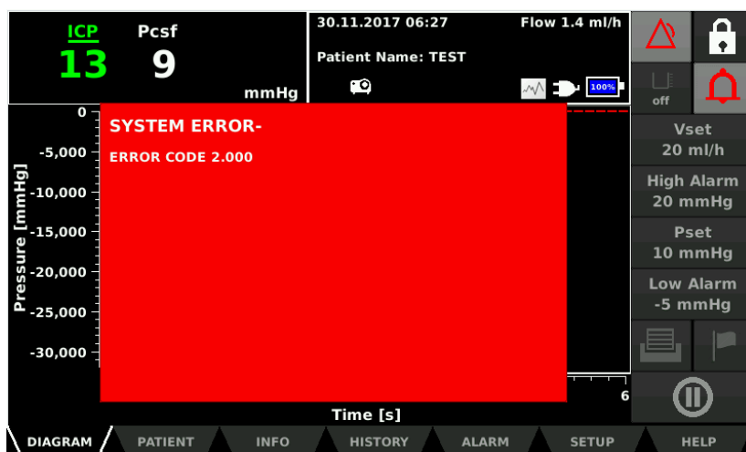
Figura 22: Configuração da janela de mensagem de alarme no caso de um erro do sistema.
